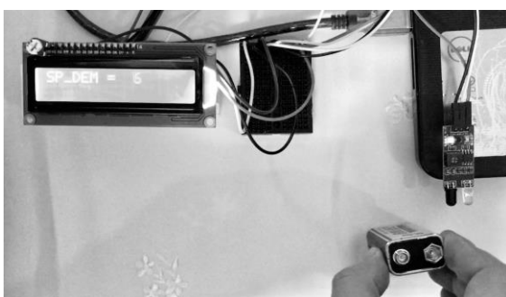
Hình 9. Màn hình LCD hiển thị nhảy số đếm khi có vật cản đi qua bộ cảm biến.
