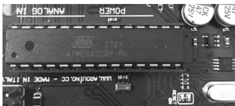
Hình 2. Vi điều khiển ATmega328P-PU tích hợp trên Arduino Uno R3.
